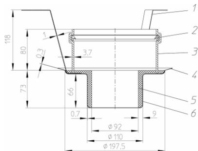
Рис. 5. Противопожарная муфта HL850 для кровельной воронки HL62.1BH/7.
