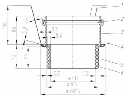
Рис. 6. Противопожарная муфта HL870 для кровельной воронки HL62.1BH/1.
