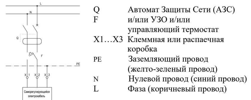
Рис. 5. Схема подключения электрообогрева кровельной воронки HL62.1BH к электрической сети.
