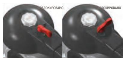
Благодаря многофункциональной рукоятке и красному фиксатору поворота, расположенному на рукоятке, можно выполнить поворот на 0-90° и пошаговый поворот с 10 промежуточными положениями и стопорной блокировкой: рукоятку можно заблокировать в любом из 10 положений, просто нажав на фиксатор поворота Free-Lock. Помимо этого, можно установить на рукоятку навесной замок для защиты оборудования от несанкционированного доступа.
