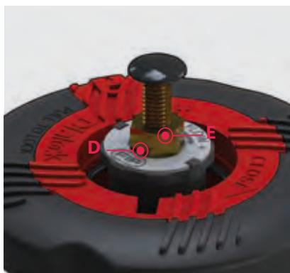
Мембранный клапан исполнения DKL оснащен системой регулирования хода маховика, позволяющей установить максимальную и минимальную пропускную способность клапана и предупреждать слишком сильное сжатие мембранны при закрытии.
