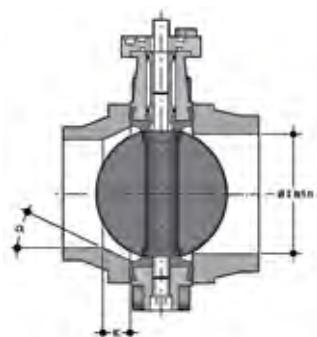
Прежде чем приступить к установке фланцевых соединений, проверьте, чтобы внутренний диаметр бурта под фланец имел достаточный зазор, позволяющий диску затвора осуществлять полный поворот. (l min). Также следует проверить максимальную монтажную длину для уплотнения. Перед установкой затвора FE следует проверить, что проходной диаметр бурта под фланец позволяет правильно открыть диск.
