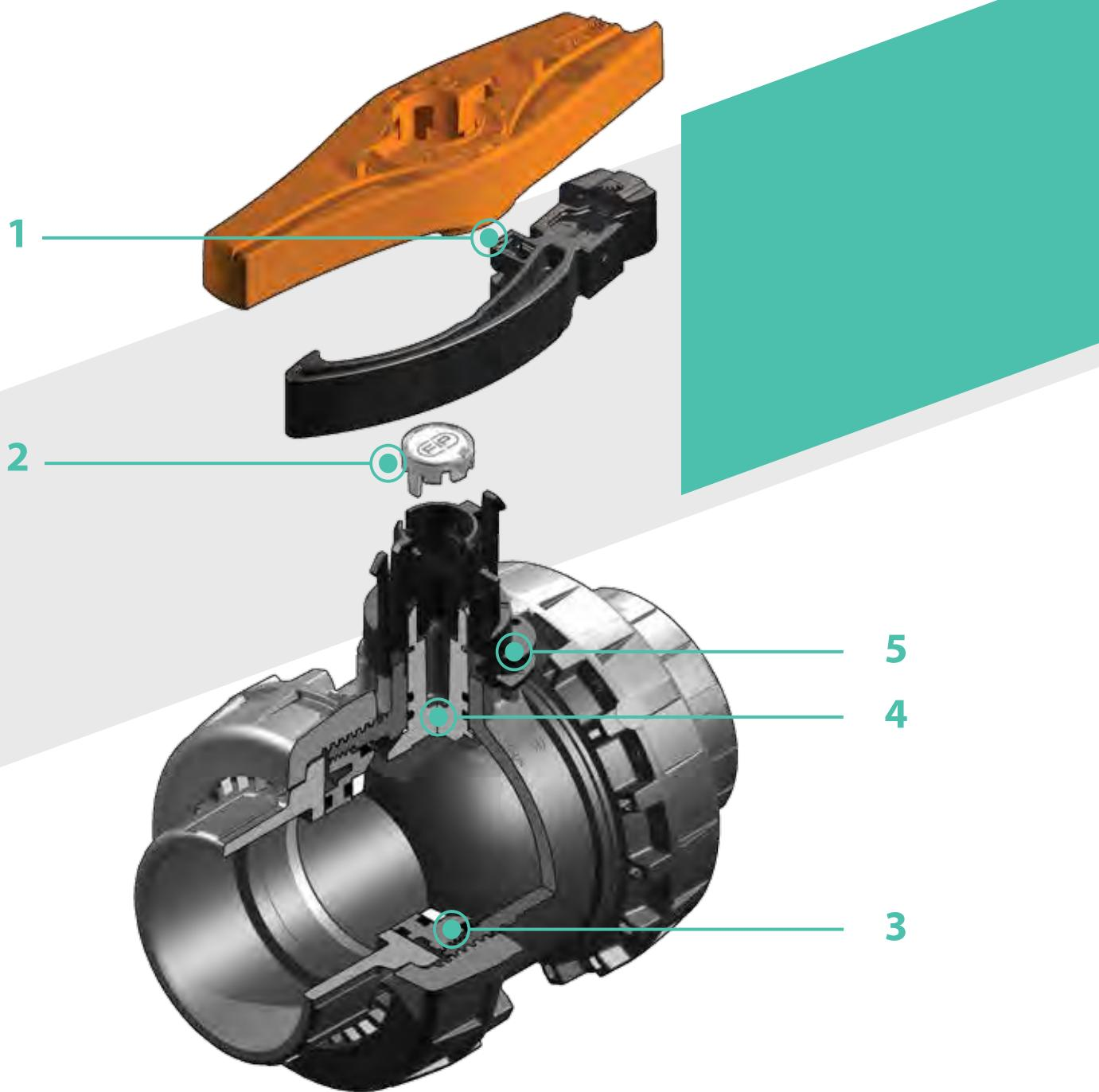
**1** Многофункциональная эргономичная рукоятка Easyfit, состоящая из центральной втулки, жестко соединенной со штоком управления, и **двусторонней ручки**, которая легко отсоединяется и используется в качестве ключа **для регулировки уплотнений шара** и как **инструмент для затяжки гаек**, благодаря вставному вкладышу, который идеально совпадает с профилем наружной поверхности гаек и позволяет трансформировать рукоятку в ключ для затяжки и ослабления
