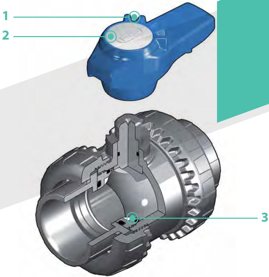
**1** Многофункциональная эргономичная рукоятка Easyfit с функцией регулировки опоры уплотнительных прокладок шара. Использование рукоятки особенно рекомендуется для операций техобслуживания, выполняемых в ограниченном пространстве при затрудненном доступе
