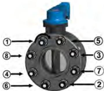
Прежде чем приступить к затяжке монтажных шпилек, рекомендуется открыть затвор, чтобы не повредить уплотнение. Монтажные шпильки/болты затягивают с одинаковым усилием (согласно приведенной ниже таблице) в порядке, соответствующем нумерации на рисунке. Чтобы обеспечить идеальное герметичное соединение, не следует прилагать чрезмерные усилия при затяжке монтажных шпилек.
