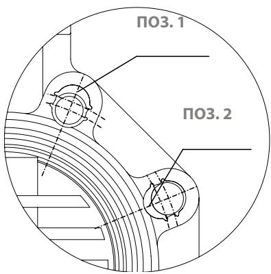
Вставьте центрирующие вкладыши в отверстия, соблюдая указанное в таблице положение, с той стороны, где нанесена маркировка с указанием D и DN, чтобы облегчить установку монтажных шпилек и соединение с фланцами (DN 40 ÷ 200). Центрирующие вкладыши вставляются в специальные направляющие пазы на корпусе затвора со стороны корпуса с нанесенной маркировкой символами вверх и размещаются в соответствии с отверстиями фланцев, как показано в таблице:
