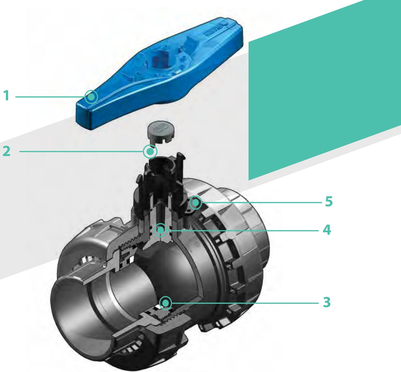
**1** Многофункциональная эргономичная рукоятка Easyfit, состоящая из центральной втулки, жестко соединенной со штоком управления, и двусторонней ручки, которая легко отсоединяется и используется в качестве ключа для регулировки уплотнений шара
