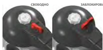
Благодаря многофункциональной рукоятке и красному фиксатору поворота, расположенному на рукоятке, можно выполнить поворот 0°- 90° и пошаговую регулировку с 10 промежуточными положениями и стопорной блокировкой: рукоятку можно заблокировать в любом из 10 положений, просто нажав на фиксатор поворота Free-Lock. Помимо этого, можно установить на рукоятку навесной замок для защиты оборудования от несанкционированного доступа.
