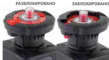
Клапан DK оснащен системой блокировки маховика DIALOCK®, препятствующей управлению клапаном. Эту систему можно активировать, подняв маховик после достижения нужного положения (рис. 8). Чтобы разблокировать управление, достаточно перевести маховик в первоначальное положение, нажав на него (рис. 6). Кроме того, когда система заблокирована, можно установить навесной замок для защиты системы от несанкционированного доступа (рис. 9).
