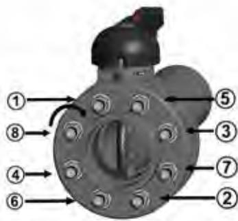
Прежде чем приступить к затяжке монтажных шпилек, рекомендуется открыть диск затвора, чтобы не повредить уплотнение. Монтажные шпильки затягиваются равномерно в порядке, соответствующем нумерации на рисунке, с крутящими моментами затяжки, приведенными в таблице.
